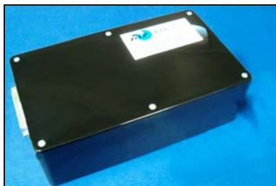
Cette « boîte noire » permet de convertir des protocoles indicateur-imprimante comme des protocoles indicateur-indicateur lors du remplacement de l'indicateur dans une installation. Cette appareil s'insère dans la liaison RS232 et rend transparent les communications d'un coté comme de l'autre.
