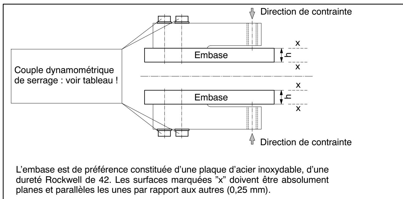
Le peson est à fixer fermement par les trous de montage, comme une poutrelle rapportée. La charge sera appliquée par la suite à l'autre extrémité. Les boulons recommandés ainsi que leurs couples de serrage respectifs sont indiqués par le tableau ci-dessous:
