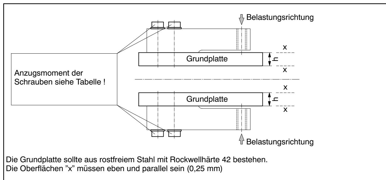
Die Wägezelle ist wie ein Kragbalken an den Montagebohrungen fest einzuspannen. Am anderen Ende wird später die Last eingeleitet. Die empfohlenen Schrauben und Anzugsmomente entnehmen Sie bitte nachfolgender Tabelle:
