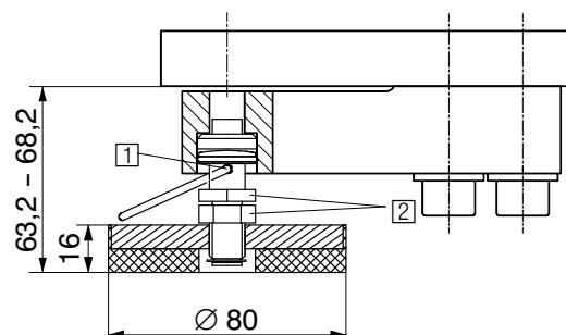
① Lastfuß in der Wägezelle mit beiliegendem Bügel gesichert
