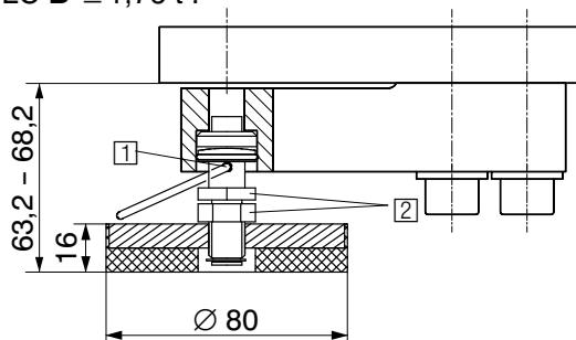
① Pied de charge dans le peson arrêté par l'étrier de sécurité ci-joint
