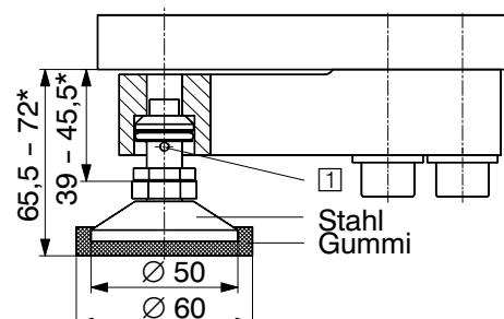
① Lastfuß in der Wägezelle mit beiliegendem Bügel gesichert
