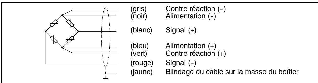
Dans le cas des versions à 6 fils raccordés en technique à circuits en quatre fils, les conducteurs **bleu et vert**, ainsi que **noir et gris** sont respectivement à relier entre eux. Lorsque les câbles **non raccourcis** (3 m) sont utilisés, il y a les écarts suivantes :
