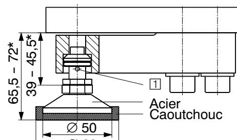
① Pied de charge dans le peson arrêté par l'étrier de sécurité ci-joint
