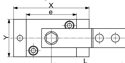
Maximal zulässige seitliche Verschiebung (bei Belastung mit Nennlast): HLCB/1.76T/ZEL: 4,5 mm
