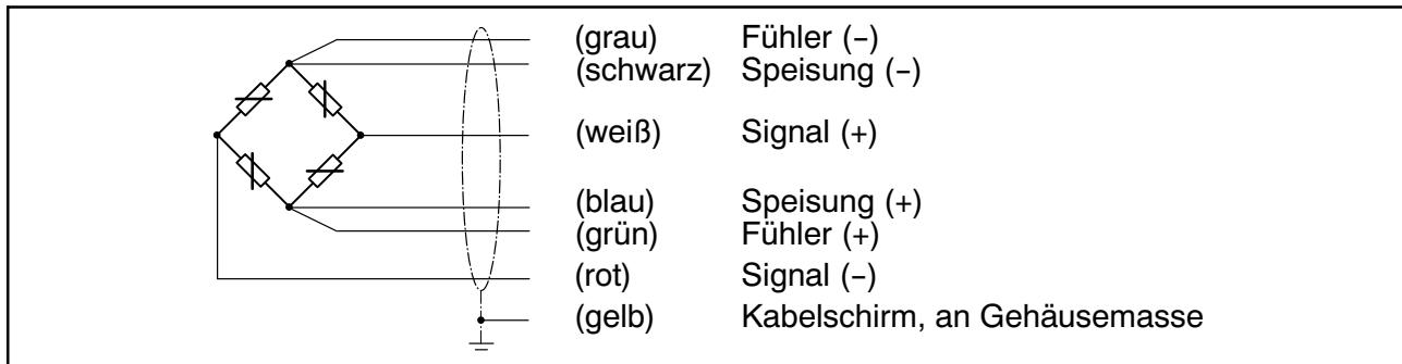
Bei Anschluss von Sechsleiter-Wägezellen an Verstärker in Vierleitertechnik sind die Adern **blau mit grün** und **schwarz mit grau** zu verbinden.
